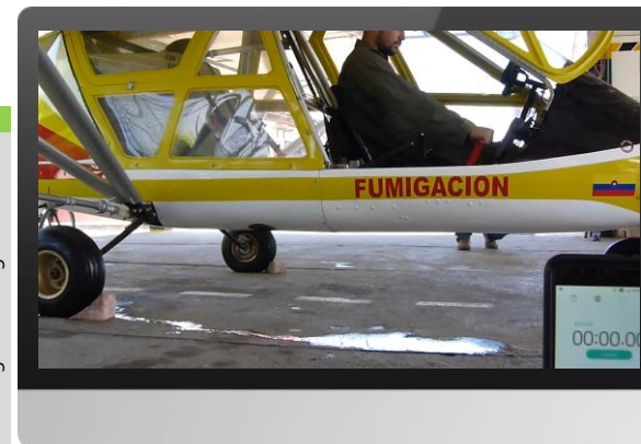
Descarga de emergencia
